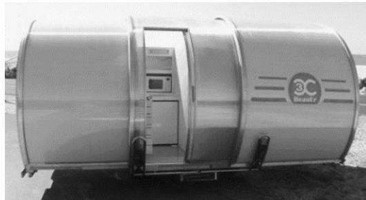
De caravan heeft de vorm van een cilinder, waarvan onderaan een gedeelte afgesneden is. De caravan is een soort buis die aan beide kanten uitgeschoven kan worden, zodat de breedte bijna drie keer zo groot wordt.
